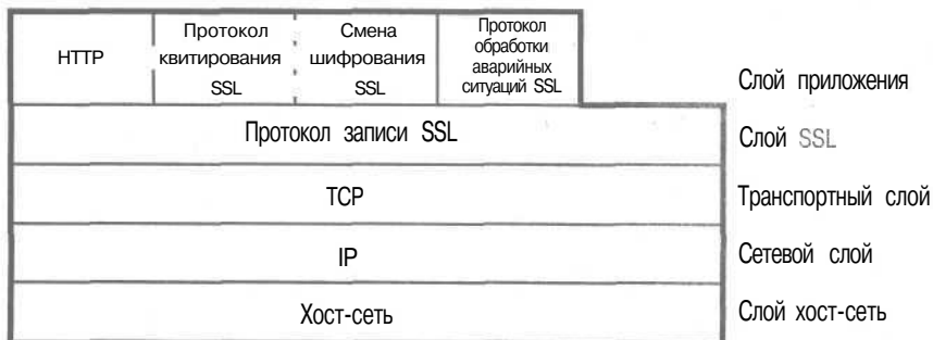
РИСУНОК 15.3 SSL добавляет дополнительный слой в стек протоколов, а также в слой приложения — для управления своими действиями.
