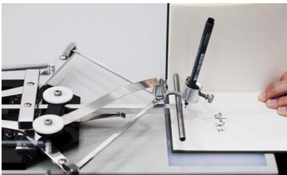
Мал. 2. Прилад для механічного нанесення підпису «Autopen Model PT»
