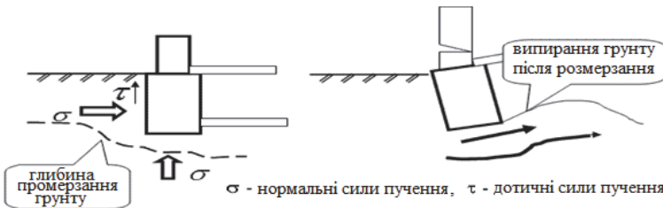
Рис. 6. Зміни властивостей ґрунтової основи внаслідок морозного пучення
