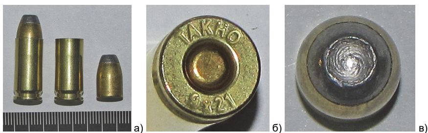
Рис. 4. Загальний вигляд та елементи спорядження пістолетних патронів калібру 9×21 мм виробництва українського ЧП НПФ «ТАХО», споряджених експансивною кулею типу «HP» масою 8,0 г. (поз. а); маркувальні позначення патрона (поз. б); вид головної частини кулі (поз. в)
