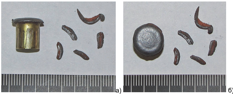
Рис. 27. Характер деформації кулі типу «HP» патрона виробництва ЧП НПФ «ТАХО» після влучення в імітатор біологічних тканин (вид кулі збоку – поз. а; вид кулі зверху – поз. б)
