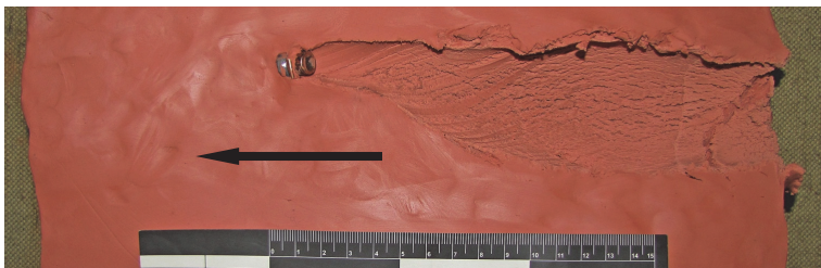
Рис. 19. Загальний вигляд характеру каналу пошкодження, спричиненого блоку балістичного пластиліну у результаті влучення кулі «SP» патрона виробництва чеської фірми «Sellier & Bellot» з відстані 25 м., швидкість кулі у момент влучення 354,5 м/с (напрямок руху кулі позначено стрілкою); постріл із карабіна «ČZ Scorpion EVO 3 S1»
