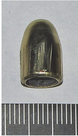
Рис. 16. Стан кулі типу «FMJ» патрона виробництва ЧП НПФ «ТАХО» після влучення в імітатор біологічних тканин
