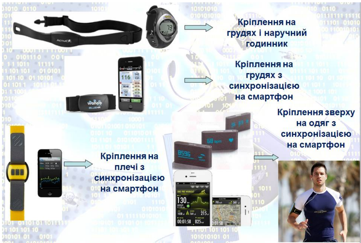
Рис.3. Використання сенсора для визначення часу, пройденої дистанції, швидкості й кількості витрачених калорій
