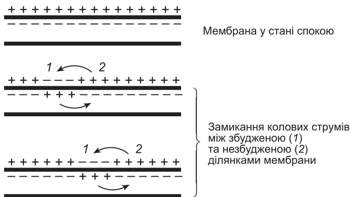
Рис. 3.17. Схема замикання колових струмів при поширенні потенціалів дії
