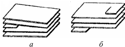
Рис. 1.4. Типи дислокацій: a – крайова; б – гвинтова
