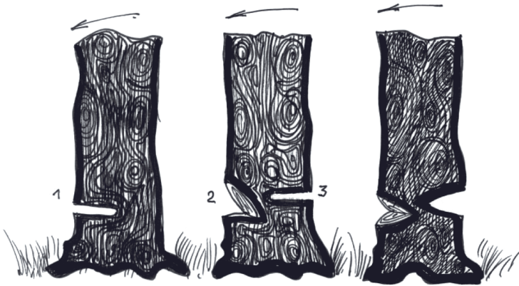
Рис. 9. Черговість запилів (1, 2) та підрубів (3) при рубанні
