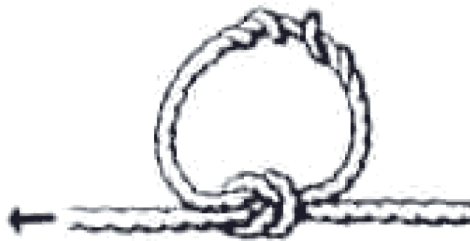
Рис. 19 а. Прямий вузол для виключення непридатної до навантаження мотузки
