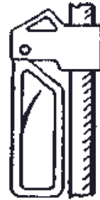
Рис. 18. Затискач для підйому та спуску по мотузці («жумар»)
