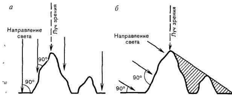
Рис.7.7. Схема освітленості поверхонь а — прямовисне, б — косе (бічне) освітлення
