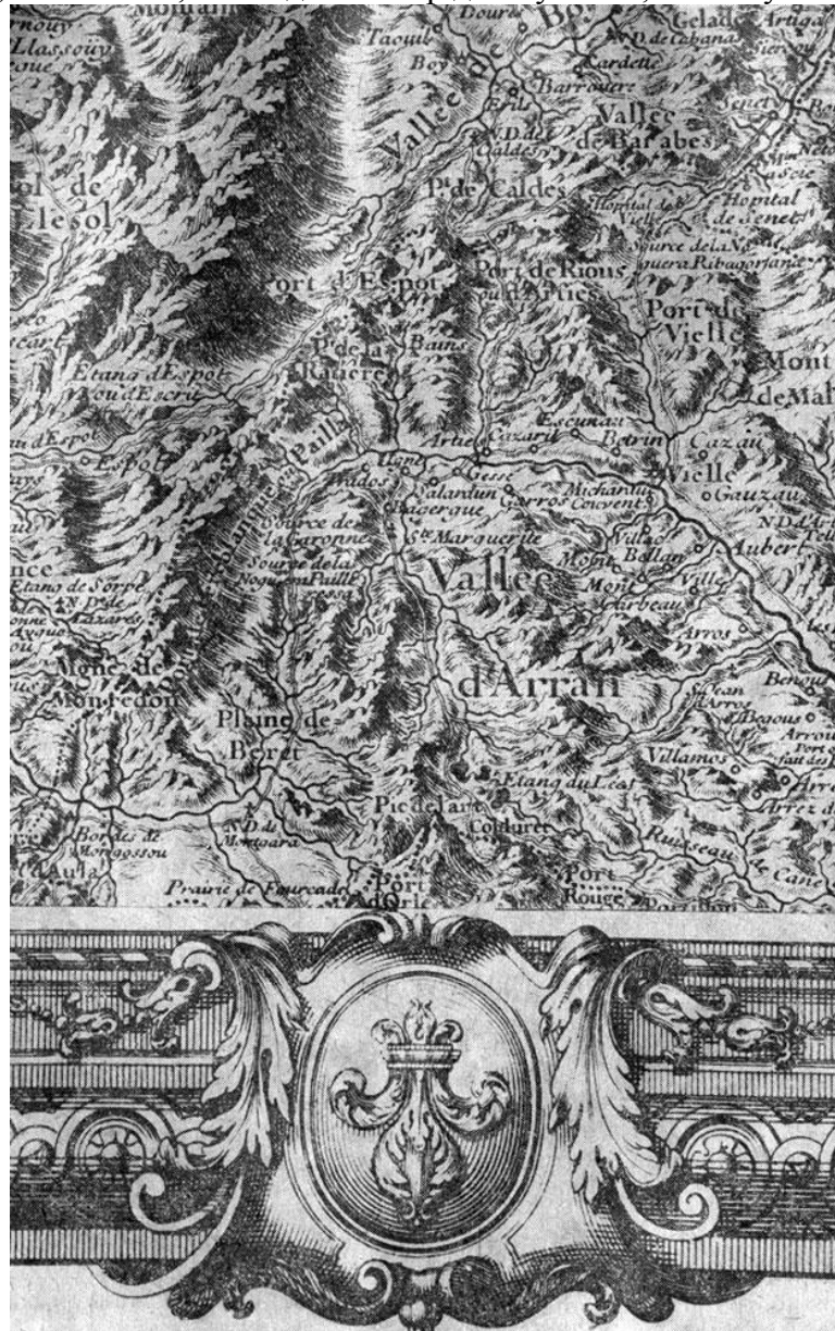
Рис.7.2. Перспективне зображення рельєфу. Фрагмент карти Піренейських гір, складеної Русселем та виданій в 1730 р. в масштабі 1 : 320 000.
