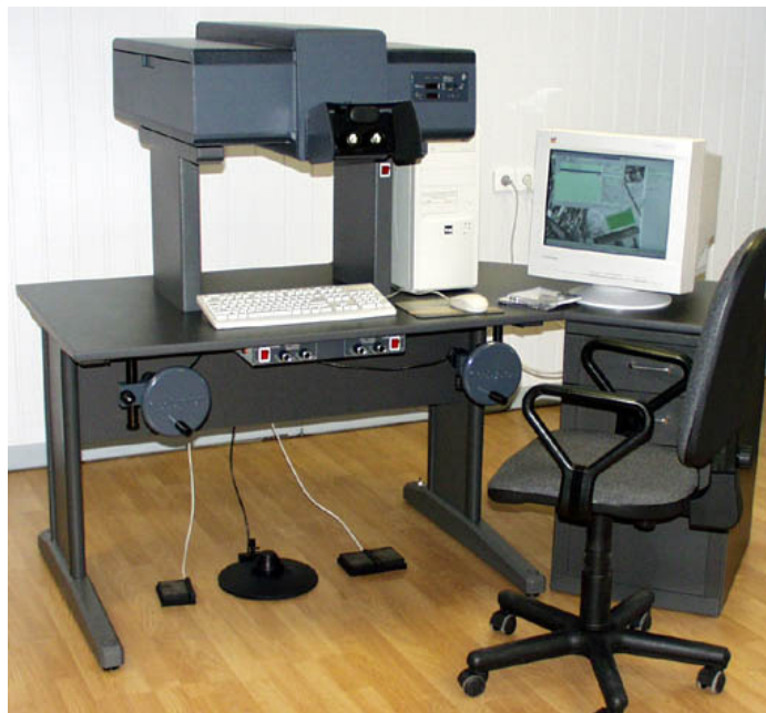
Рис. 97. Аналітична фотограмметрична станція «Стереонаграф»
