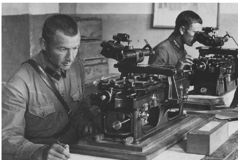
Рис. 230. Фотограмметричне опрацювання аерознімків
