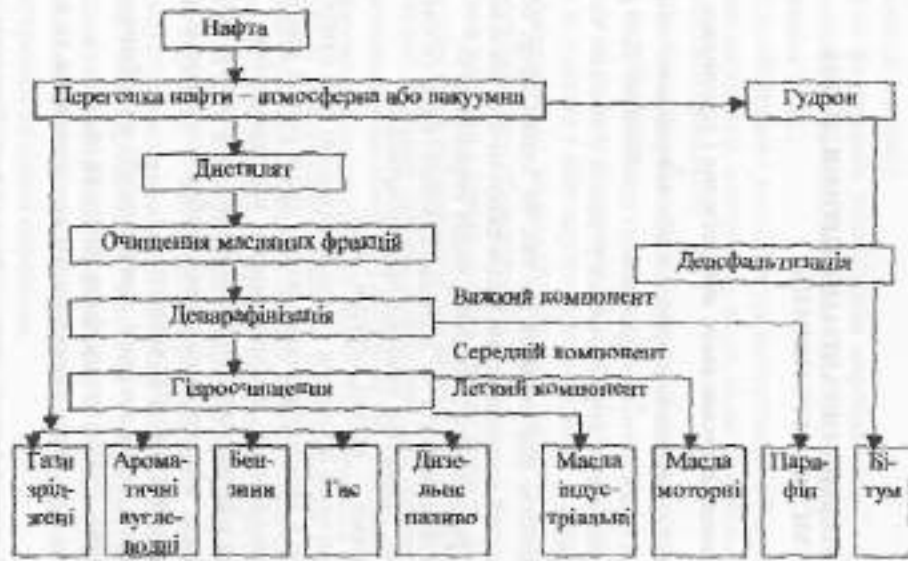
Рис. 34. Технологічні процеси переробки нафти (безсірчанеста нафта, масляний варіант)
