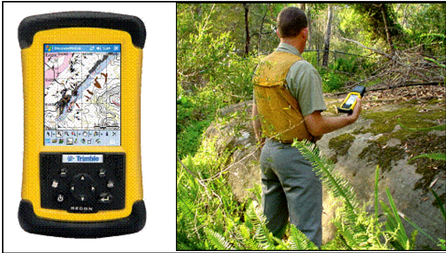
Рис.У.14 Використання й отримання на місцевості просторових даних із застосуванням мобільного комп'ютера з приєднаним GPS-приймачем і засобів пакета програмного забезпечення Encom Discover Mobile ГІС-інструментарію MapInfo Professional (за [124, 48])
