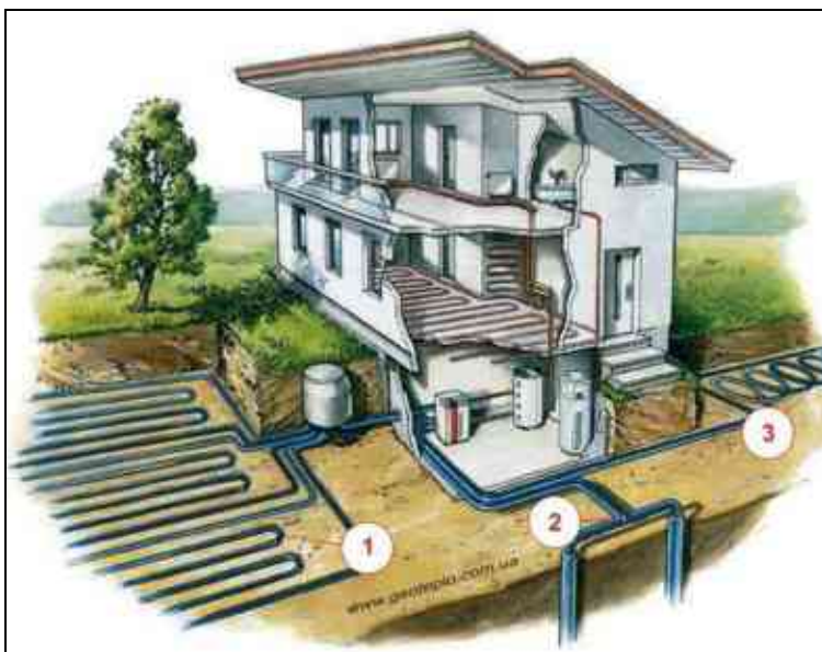
Рис. 43. Система теплових насосів типу «Земля-Вода»:
