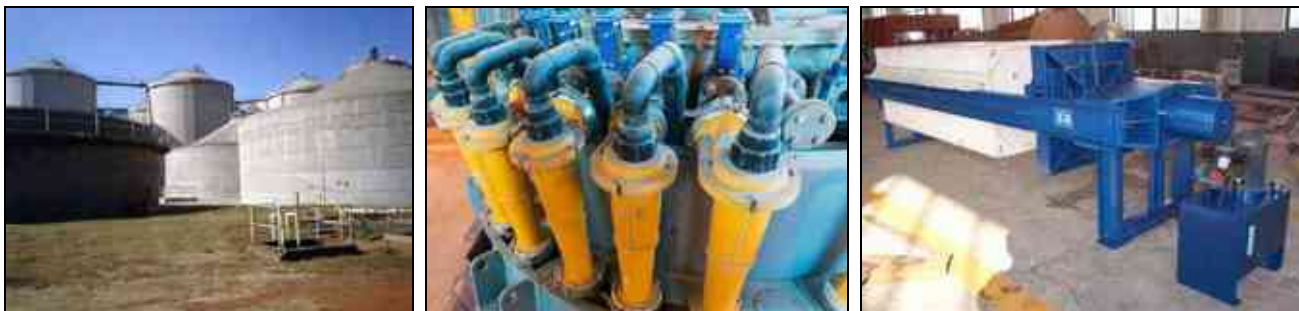
Рис. 81. Метантенк (ліворуч), гідроциклон, прес-фільтр (праворуч)
