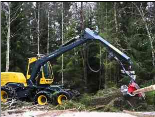
Рис. 109. Харвестер Eco Log для проріджування і доглядових рубок
