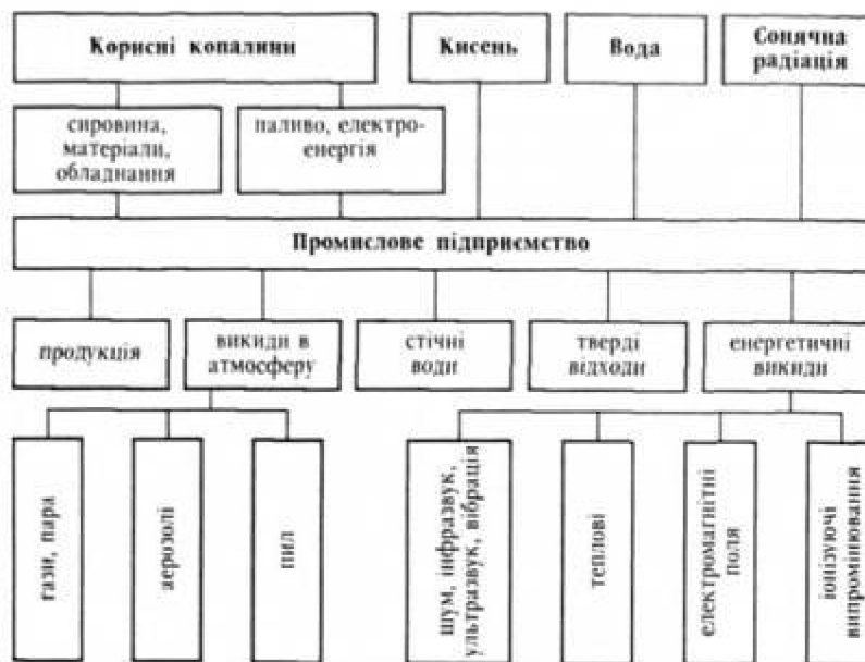
Рис. 8 - Обмін речовинами та енергією сучасного промислового підприємства з навколишнім середовищем
