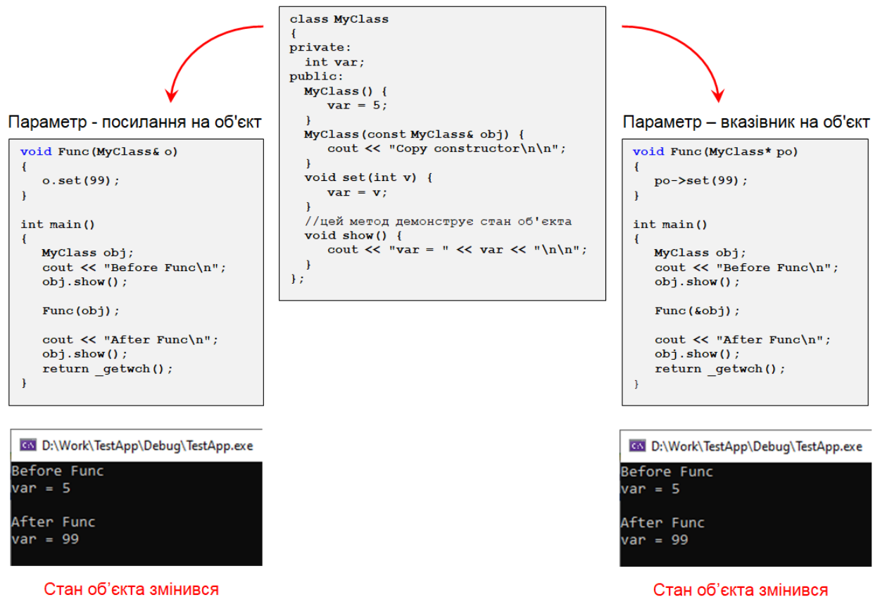
Рис. 9.3. Порівняння вказівника і посилання у якості параметру функції
