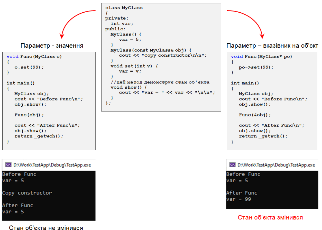
Рис. 9.2. Два способи передачі об'єкта у якості параметру функції
