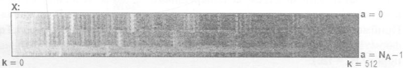
Рис. 5.114. Візуалізація транспонованого масиву спектрального розподілу потужності X (світлі ділянки відповідають більшій потужності; максимально — 96.33 дБ)
