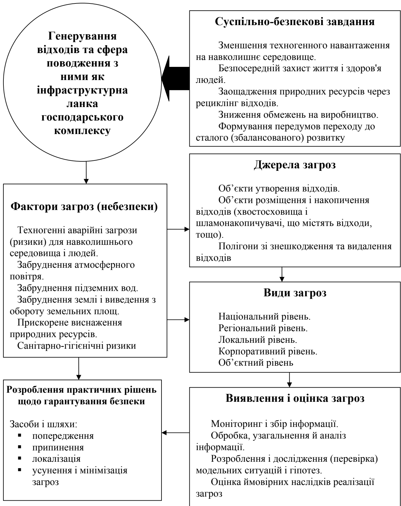
Рис. 6.1. Узагальнена система виникнення і попередження загроз, пов'язаних з генеруванням і накопиченням відходів
