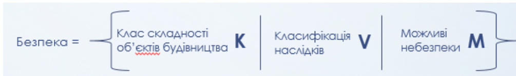
Рис. 4.2.1. Формалізована модель-схема управління безпекою на стадії планування проектів з масовим перебуванням людей з врахуванням категорії складності
