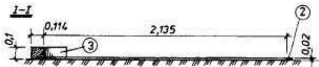
Рис. 11. Сектор для штовхання ядра (розміри в метрах): 1 – бетонний чи асфальтобетонний горизонтальний майданчик, 2 – металеве кільце, 3 – дугоподібний брусок, 4 – сектор для приземлення ядра, 5 – зона безпеки.
