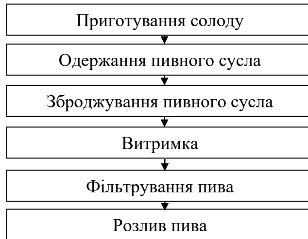
Рисунок 6.13 – Технологічна схема виробництва пива
