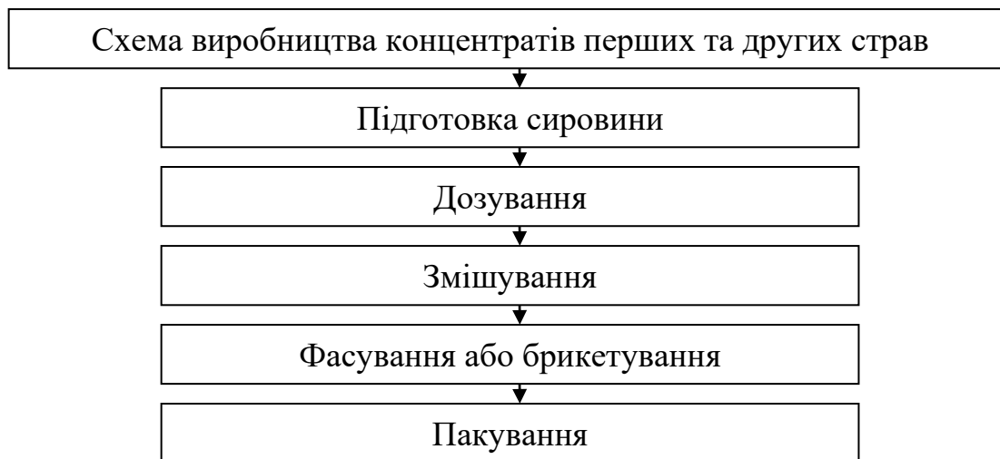
Рисунок 12.8 – Схема виробництва концентратів перших та других страв
