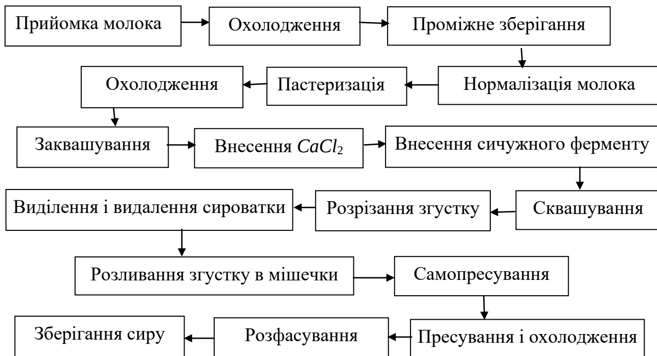
Рисунок 8.18 – Схема отримання сиру кислотно-сичужним способом
