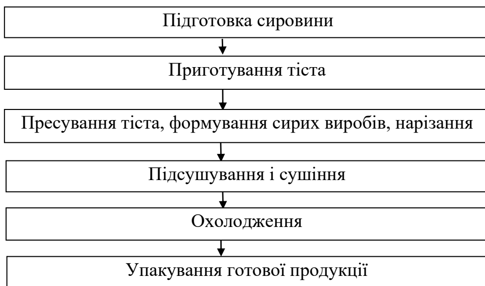
Рисунок 2.10 – Схема виробництва макаронних виробів
