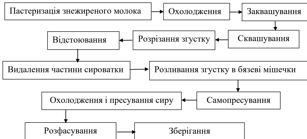
Рисунок 8.19 – Схема отримання сиру кислотним способом
