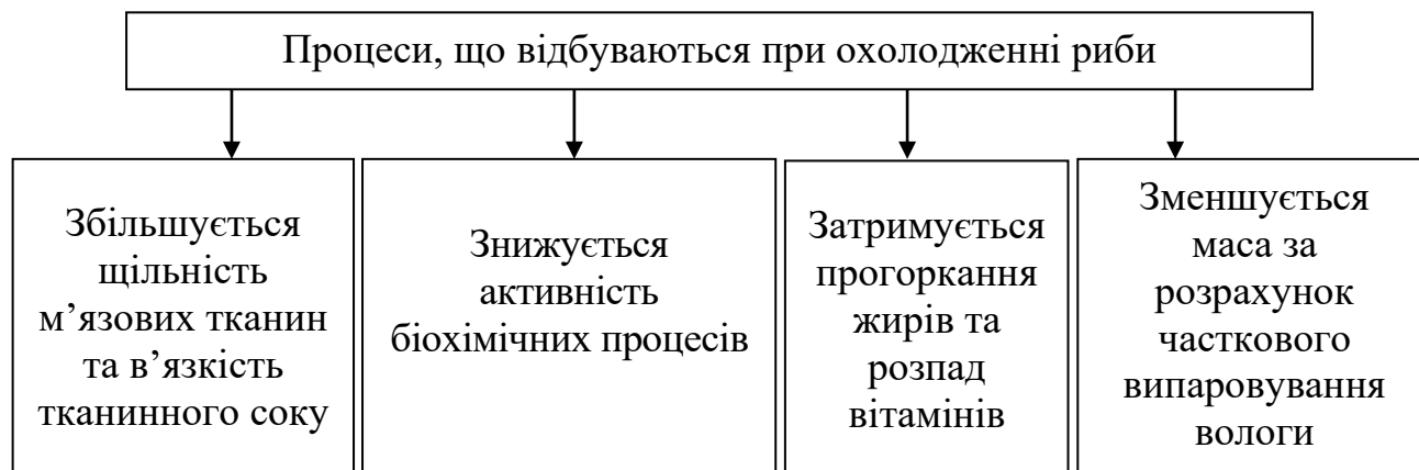
Рисунок 11.5 – Процеси, що відбуваються при охолодженні риби
