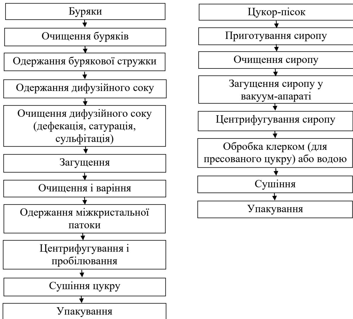
Рисунок 4.6 – Схема виробництва цукру-піску та цукру-рафінаду
