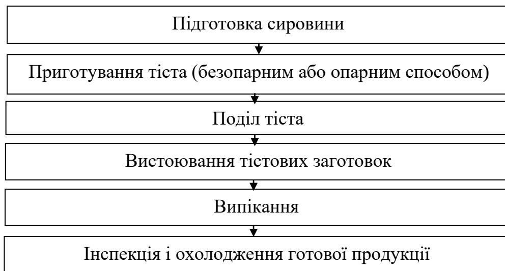
Рисунок 2.8 – Загальна схема виробництва хліба
