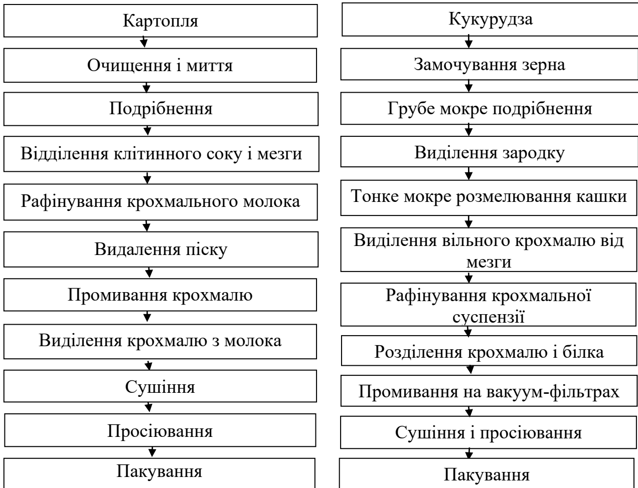
Рисунок 4.3 – Схеми виробництва картопляного і кукурудзяного крохмалю
