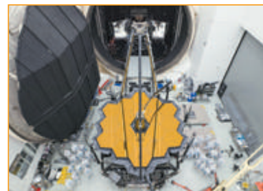
Рис. 3.2 Сегментоване дзеркало новітнього космічного телескопа «Джеймс Вебб»
