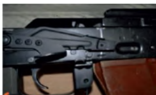
Іл. 34.4. Установлення перевідника на необхідний вид вогню: а — для ведення автоматичного вогню; б — для ведення поодинокого вогню
