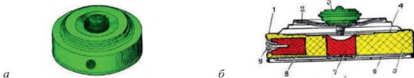
Іл. 47.2. Протитанкова міна ТМ-57 з підривиком МВ3-57: а — загальний вигляд в транспортному положенні; б — розріз в бойовому положенні; 1 — корпус; 2 — щиток; 3 — підривик МВ3-57; 4 — діафрагма; 5 — заряд; 6 — дно; 7 — центральний детонатор; 8 — бічний детонатор; 9 — пробка
