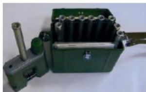
Іл. 70.3. Комплект ІД-1: 1 — індивідуальний дозиметр; 2 — зарядний пристрій
