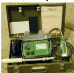
Іл. 69.7. Вимірювач потужності доз ІМД-5
