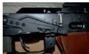
Іл. 34.4. Установлення перевідника на необхідний вид вогню: а — для ведення автоматичного вогню; б — для ведення поодинокого вогню
