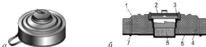
Іл. 47.1. Протитанкова міна ТМ-62М: а — загальний вигляд міни з підривачем МВЧ-62 в транспортному положенні; б — розріз міни без підривача (з пробкою): 1 — корпус; 2 — пробка; 3 — прокладка; 4 — заряд; 5 — дно; 6 — додатковий детонатор; 7 — вушко для кріплення ручки
