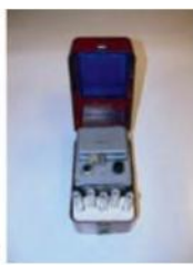
Іл. 70.1 а, б. Комплекти індивідуальних дозиметрів ДП-22В (а) і ДП-24 (б)
