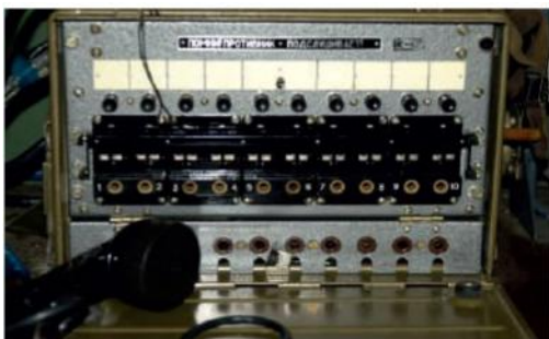
Іл. 49.2. Польовий телефонний комутатор П-193М
