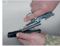
Іл. 35.5. Відокремлення затвора від рамки
