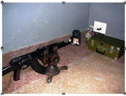
Лл. 33.3. Кріплення автомата на прицільному верстаті ПС-51
