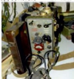
Іл. 48.2. Радіостанція Р-105М
