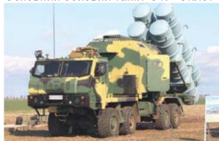
Комплекс крилатих ракет наземного базування «Нептун», призначений для ураження бойових кораблів і берегових радіоконтрастних цілей
