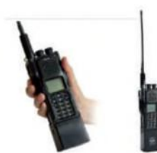
Іл. 48.6. Радіостанція PRC-9651
