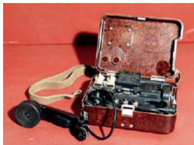
Іл. 49.1. Телефонний апарат ТА-57
