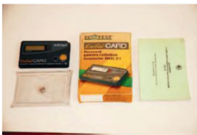
Іл. 70.7. Дозиметр гамма-випромінювання індивідуальний ДКГ-21
