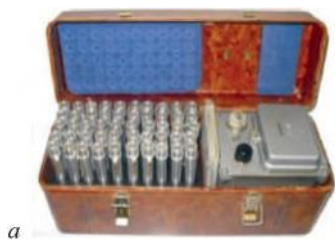
Іл. 70.1 а, б. Комплекти індивідуальних дозиметрів ДП-22В (а) і ДП-24 (б)
