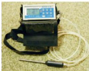
Іл. 71.4 Газосигналізатор «ДОЗОР-С-М-5Н»
