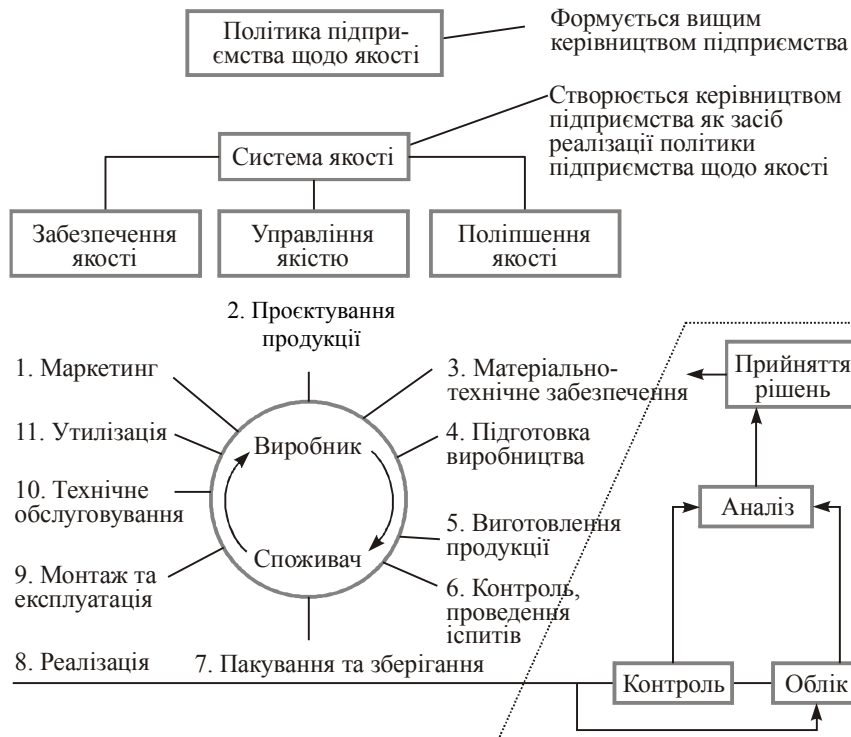
Рисунок 11.2 – «Петля якості» або типові стадії життєвого циклу продукції, на яких забезпечується її якість
