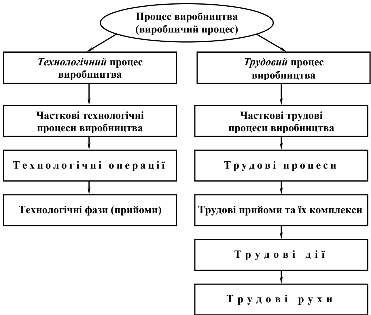
Рис. 7.1. Розчленування процесу виробництва на складові елементи для цілей нормування
