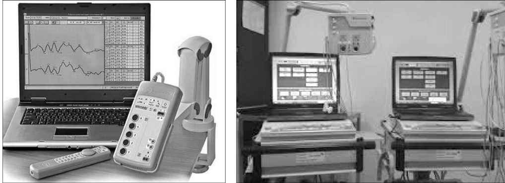
Рисунок 4.6 – Міографи для вимірювання напруження м'язів
