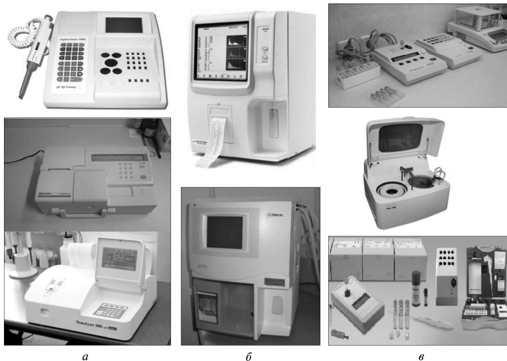
Рисунок 4.52 – Біохімічна апаратура для контролю показників крові спортсменів: a – коагулометр напівавтоматичний TS 4000, мобільний аналізатор газів крові та електролітів «OPTI CCA»; біохімічний аналізатор «Humalyzer 3000 LP-400»; б – автоматичний гематологічний аналізатор «Micro CC-20 Plus» та гематологічний аналізатор ERMA PCE-210; в – мобільний біохімічний аналізатор-фотометр LP-420 «Dr-Lange» та аналізатор біохімічний «Vario Photometer II» (Diaglobal)
