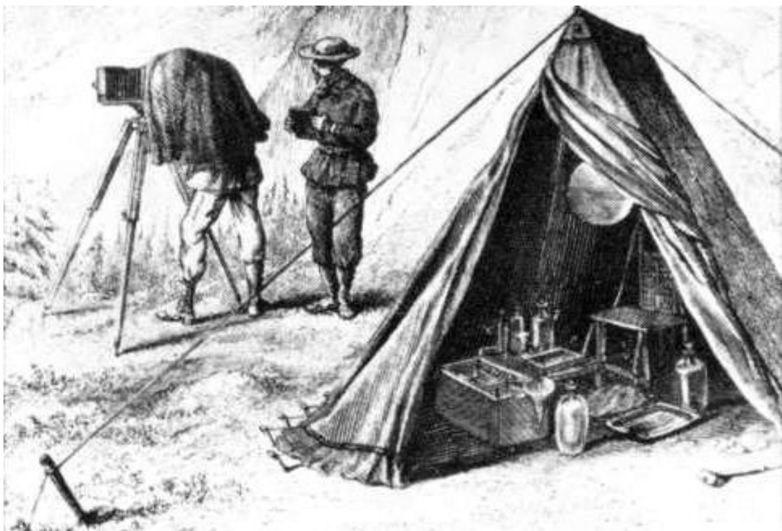
Обладнання для мокрого колодінного процесу (біля 1870 року) Гравюра на дереві.
