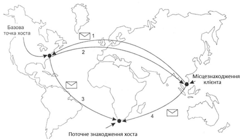
Рис. 5.9. Принцип роботи схеми мобільної IP-адреси
