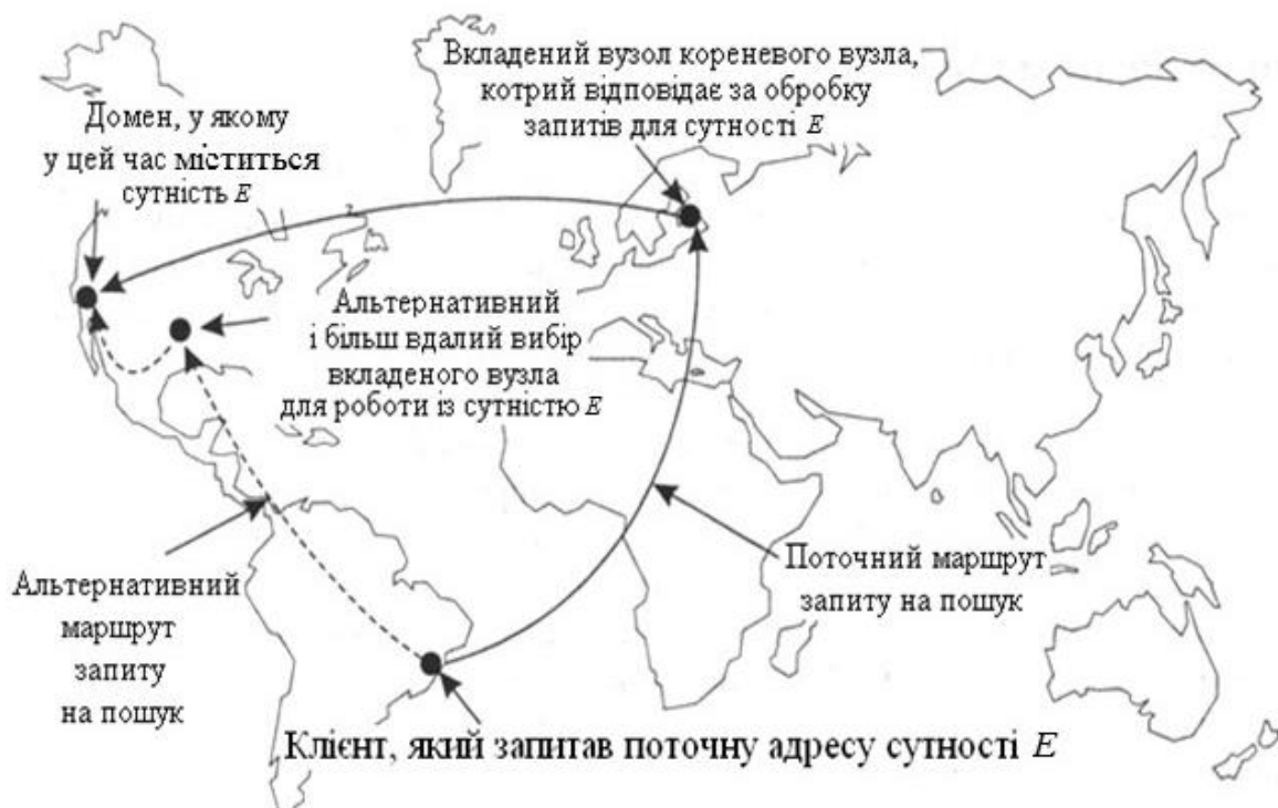
Рис. 5.16. Ілюстрація проблем масштабування у разі рівномірного розподілу вкладених вузлів розділеного кореневого вузла
