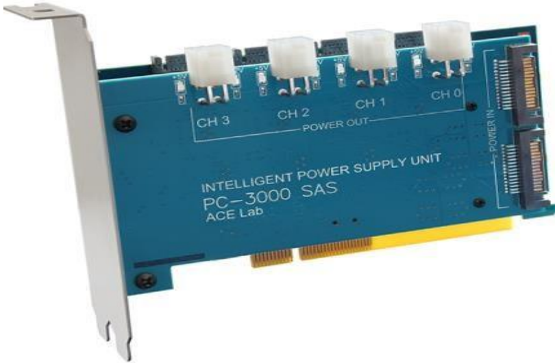
Рис. 7. Засіб для аналізу, діагностики та відновлення жорстких дисків PC-3000 SAS
