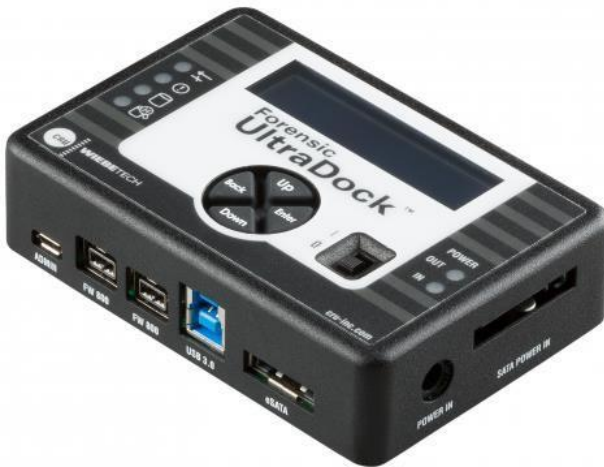
Рис. 6. Апаратний блокіратор Wiebitech Forensic UltraDock v5
