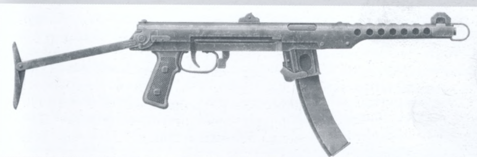
◀ 7,92 мм пістолет-кулемет ППС-43. Вага: 3,62 кг. Довжина: зі складеним прикладом – 616 мм, з відкинутим – 831 мм. Ємність секторного магазину: 35 набоїв. Скорострільність: 100 постр./хв. Прицільна дальність: 200 м.
