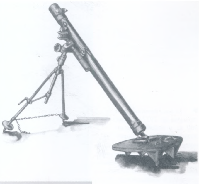
▼ 82 мм міномет зр. 1937 р. Вага: 56 кг. Скорострільність: 25–30 постр./хв. Дальність стрільби: 3040 м. Вага міни: 3,10 кг.
