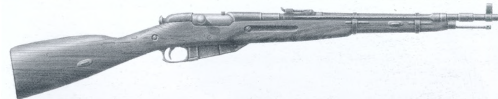
◀ 7,62 мм карабін зр. 1938 р. Вага: 3,49 кг. Довжина: 1020 мм. Ємність магазину: 5 набоїв. Скорострільність: 10 постр./хв. Прицільна дальність: 1000 м.
