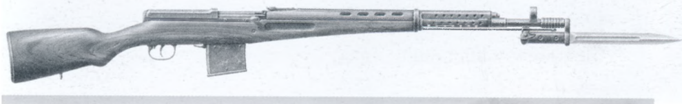
◀ 7,62 мм самозарядна гвинтівка В. Токарева СВТ 40. Вага: 4 кг. Довжина: 1226 мм. Ємність магазину: 10 набоїв. Скорострільність: 25 постр./хв. Прицільна дальність: 1500 м.
