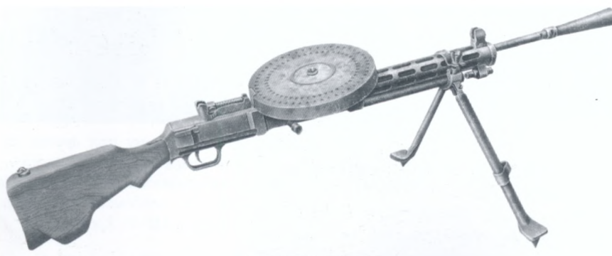
▲ 7,62 мм кулемет ДП-27 Вага: 11,9 кг. Довжина: 1270 мм. Ємність магазину: 47 набойів. Скорострільність: 80 постр./хв. Прицільна дальність: 1500 м.
