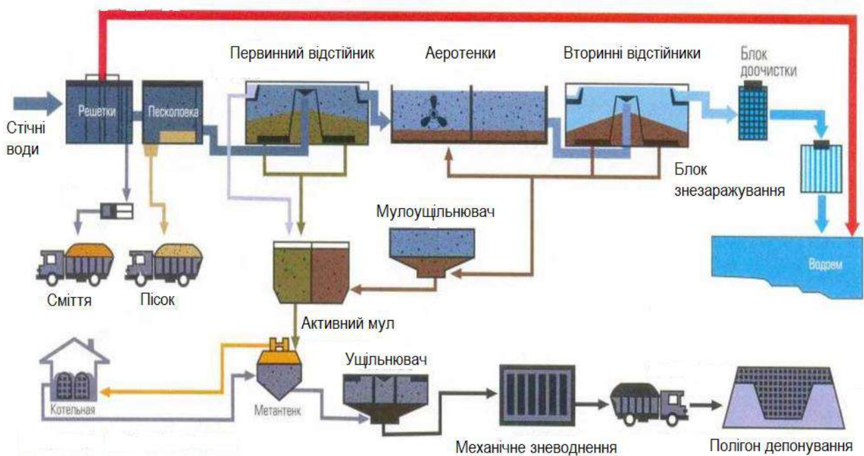
Рис. 58. Класична схема очистки стічних вод
