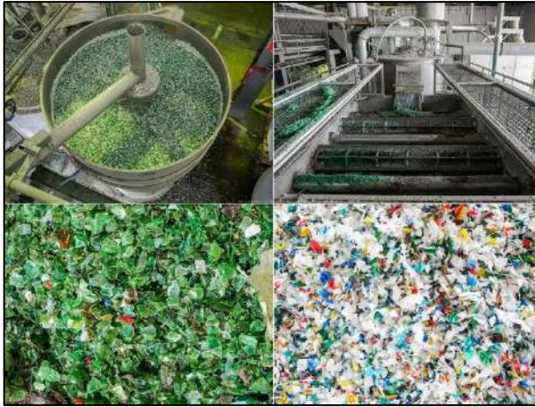
Рис. 88. Етапи технології bottle-to-bottle
