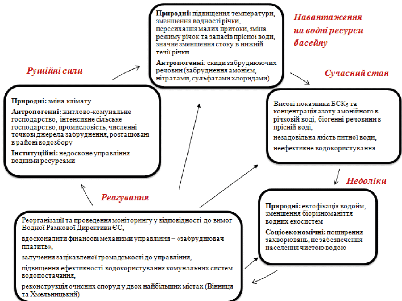
Рис. 6. Загальна система DPSIR для водних ресурсів басейну р. Південний Буг (проілюстрована авторами на основі Mattas, 2014). Fig. 6. A generic DPSIR framework for water resources of the Southern Bug River basin (illustrated by the authors based on the framework of Mattas, 2014).
