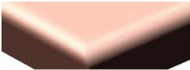
Рис. 3.1. Скруглення ліворуч забезпечує безперервність кривизни C2 між усіма поверхнями. Кривизна скруглення праворуч різко змінюється в місці з'єднання дуги і плоскої поверхні
