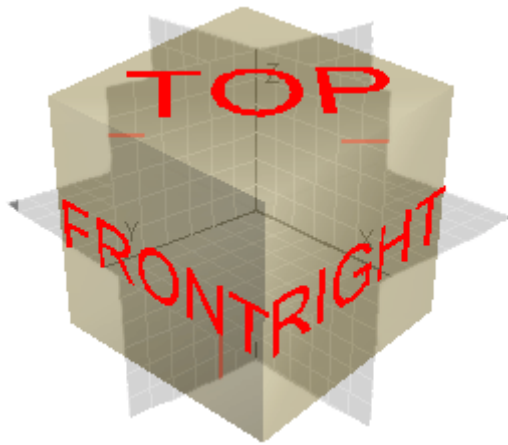
Рис. 5.2. Ортогональні види звернені до початку координат з шести фіксованих напрямків
