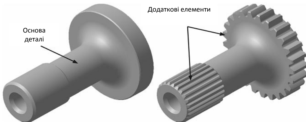
Рис. 2.12 Використання тіла вала у якості основного елемента моделі
