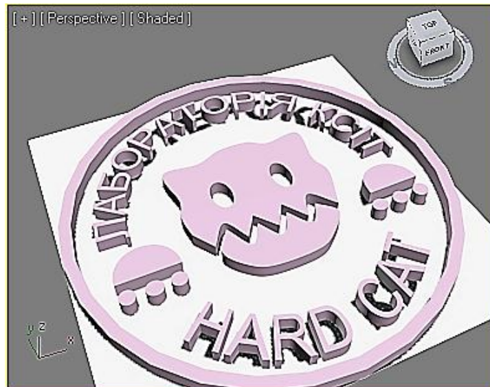
Рис. 4.30. Застосування до малюнка штампа модифікатора Extrude
