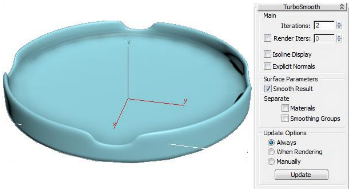
Рис. 3.32. Застосування модифікатора TurboSmooth до попільнички
