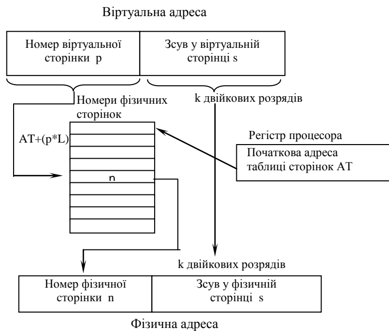
Рис. 3.6 – Перетворення адреси при сторінковому розподілі пам'яті
