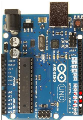
Рисунок 2.11. — Призначення ліній для вихідних сигналів керування Arduino UNO
