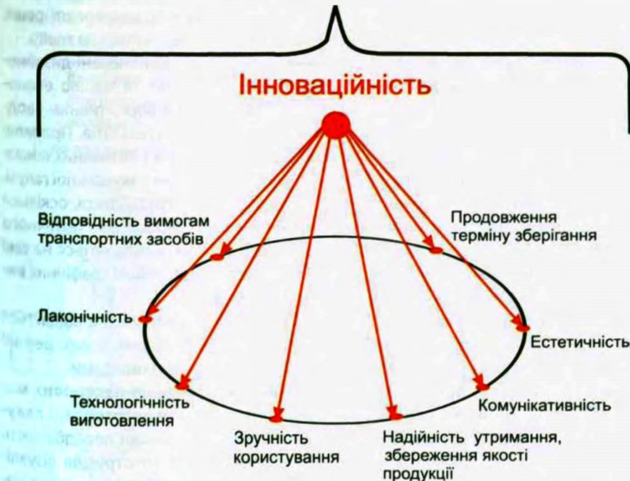
Рис. 10.2. Графічне представлення комплексу вимог до проектування пакувань, забезпечення яких дає можливість називати процес проектування дизайном
